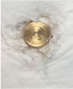
Abb. 4: Nachfüllstutzen für Glyzerin mit Stopfen [vorher Rückwand abnehmen]
