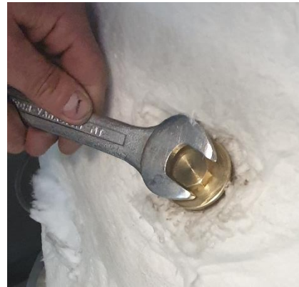
Abb. 5: Stopfen von Nachfüllstutzen abschrauben
