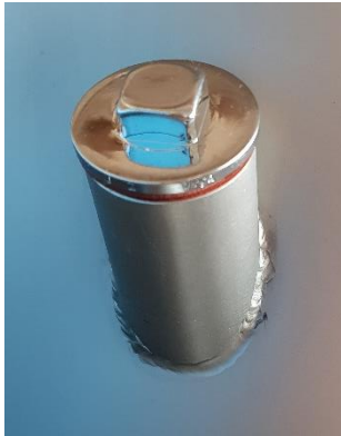
Abb. 4.: Nachfüllstutzen für Glyzerin mit Stopfen
