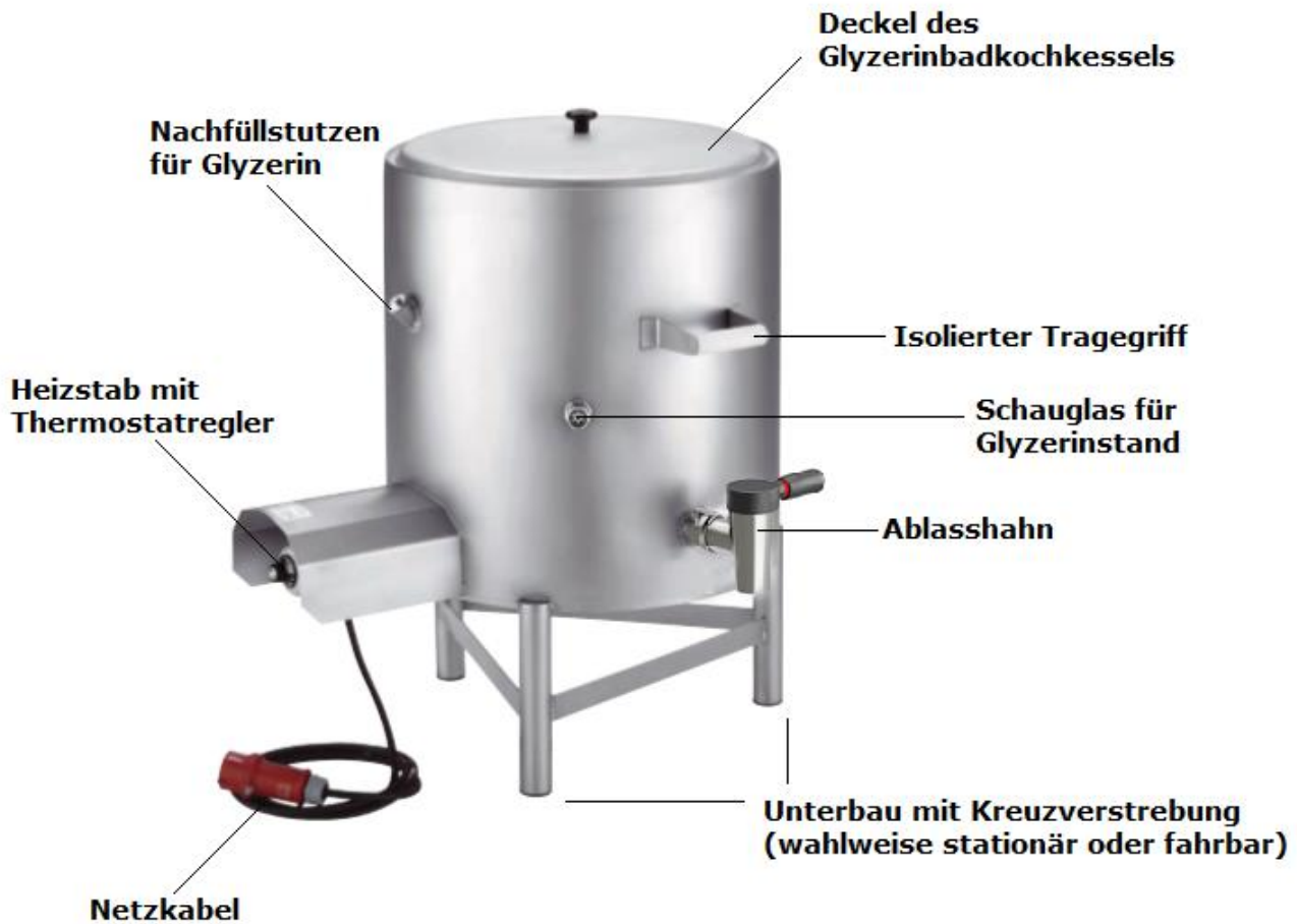
Abb.1: BASTRA-Glyzerinbad-Kochkessel KDN 120 stationär
